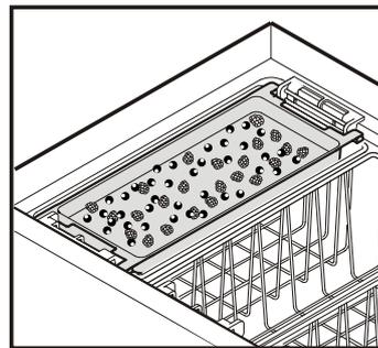
La tablette de congélation peut être posée sur le corbeille ou glissée dans la cuve pour servir de cloison de séparation (sauf modèle GT 1456).
