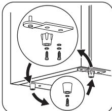
5. Enlevez la vis fixant la charnière inférieure à la porte et l'autre vis fixant la charnière inférieure de la porte et le pied de l'appareil. Retirez ensuite la charnière de la porte et le pied comme le montre l'illustration.
