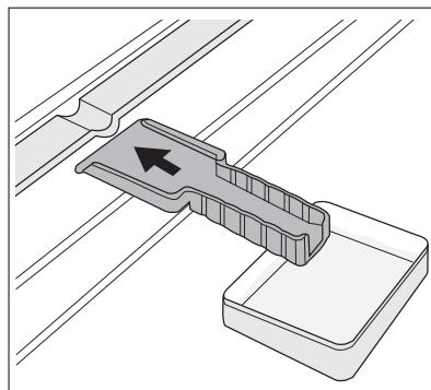
**i** Stellen Sie eine Schale mit heißem Wasser in das Gefrierfach, um den Abtauprozess zu beschleunigen. Entfernen Sie vorsichtig Eisstücke von den Wänden, bevor alles abgetaut ist.
